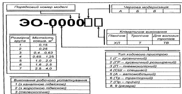
Рис. 1.1 Індексація одноковшових екскаваторів
