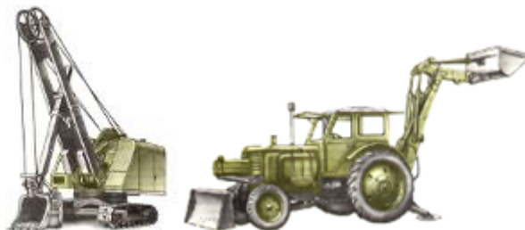
Рисунок 1.6 (а) Повноповоротний екскаватор з механічним приводом на гусеничному ході з гнучкою підвіскою робочого обладнання; (б) Неповноповоротний екскаватор з гідравлічним приводом на базі трактору зі жорсткою підвіскою робочого обладнання
